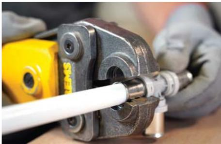
s'installe sur les tubes de la gamme Fluxo avec les mâchoires profils TH. La gamme Fluxo-ZP peut être posée facilement sur chantier puisque la conception du raccord optimise les pertes de charge. Cela permet d'éviter un surdimensionnement des réseaux dû aux pertes de charge importantes pouvant être générées par certaines solutions génériques du marché.
