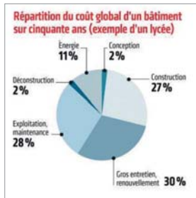
Figure P-5 Répartition des coûts d'un bâtiment
